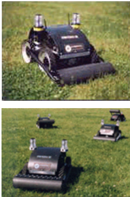
Fig. 18. FETCH II demining robot
