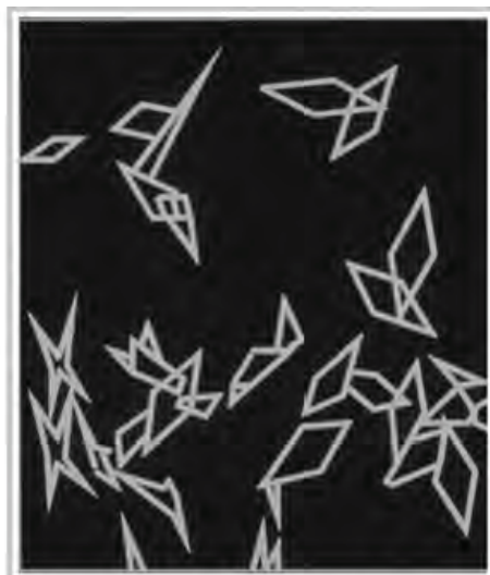
Crystal Morphology With Pour Point Depressant
