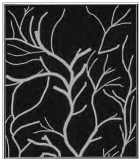
Crystal Morphology Without Pour Point Depressant
