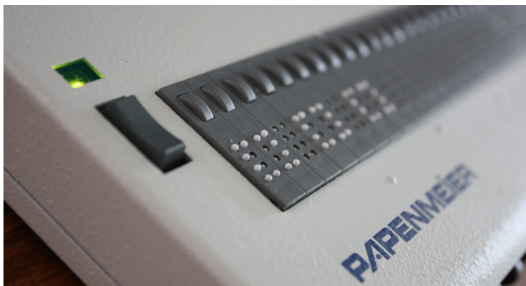
Fig. 10. Papenmeier BRAILLEX EL 40s Refreshable Braille Display
